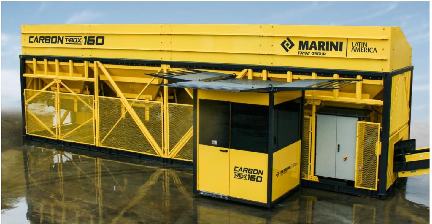
Protección de las partes móviles con fácil acceso para el mantenimiento
