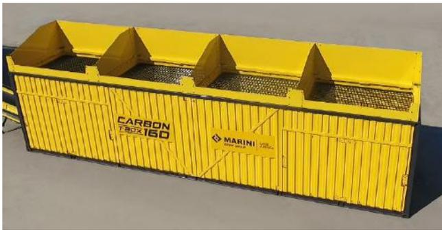
Módulo dosificador con cuatro tolvas de agregados
